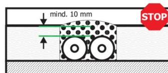
Vermibit verklebt und verkrallt im eingebauten Zustand und erfüllt damit die Anforderung "Gebundene Form" nach **DIN 18560 Teil 2**.
